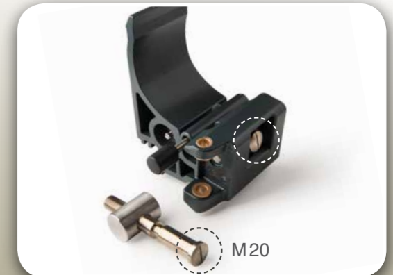
De armsteun met zijn draaikiepsysteem, zorgt niet alleen voor een blokkering tegen windstoten, maar heft ook het uitvalprofiel mooi in de kast bij sluiting. Met regelschroef M20 is de helling van uw zonnetent op elk ogenblik makkelijk aan te passen.
