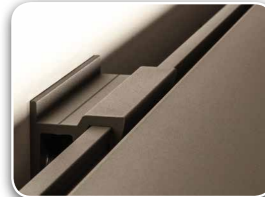
Veilige en solide inhaaksteun die de montage en demontage makkelijk maakt. Deze steun schuift over de 2mm dikke rugzijde en is verankerd met een inox inbusschroef.
