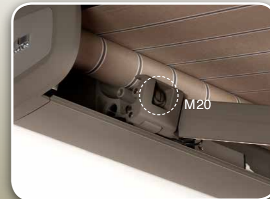
De armsteun met zijn draaikiepsysteem, zorgt niet alleen voor een blokkering tegen windstoten, maar heft ook het uitvalprofiel mooi in de kast bij sluiting. Met regelschroef M20 is de helling van uw zonnetent op elk ogenblik makkelijk aan te passen.
